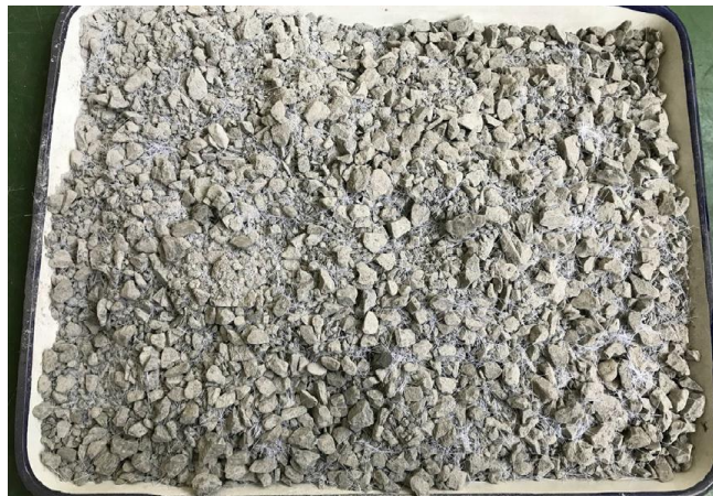
شکل ۳- اختلاط مصالح سنگی با سیم پلاستیکی ضایعاتی
