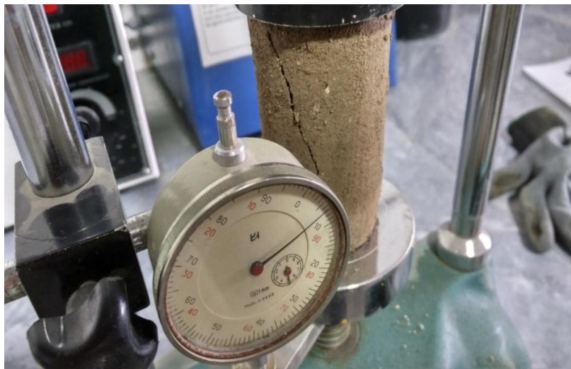
شکل ۴- تصویر گسیختگی نمونه تحت آزمایش مقاومت فشاری تک محوری
