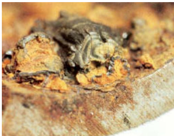
شکل ۹- ساختار مگنتیت چند لایه (بزرگنمایی ۲×۰) [۶]
