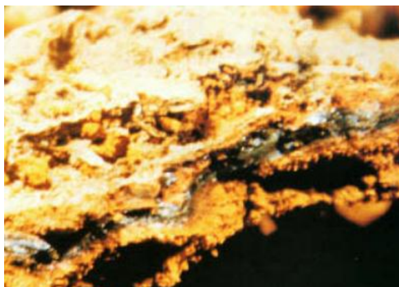
شکل ۸- سطح مقطع نواحی مختلف یک تاول: لایه خارجی، لایه مگنتیت (سیاه رنگ) و حفره داخلی (بزرگنمایی ۷.۵x). [۶]
