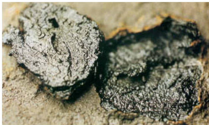
شکل ۱۷- تاولی جدا شده از سطحی که چند دقیقه در معرض هوا بوده است [۱]
