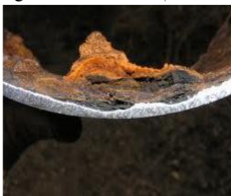
شکل ۱۳- برش عرضی خوردگی تاوولی [۶]
