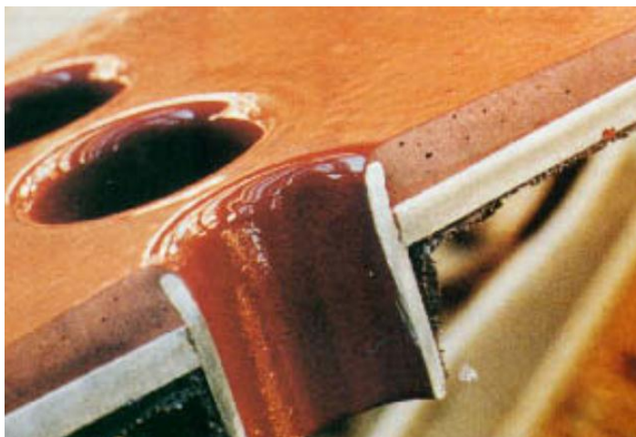
شکل ۱۹- پوشش اپوکسی اعمالی بر سطح قطعه مستعد به تاول زدگی [۶]
