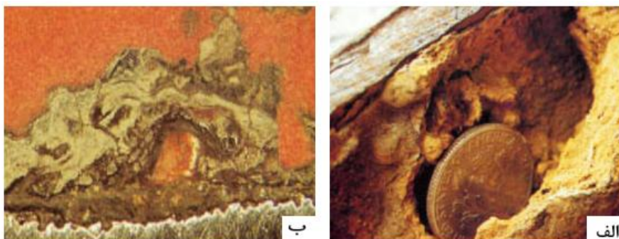
شکل ۱۲- شکاف‌های بزرگ (الف) و کوچک (ب) درون حفره [۶]
