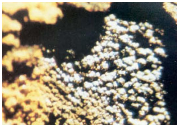
شکل ۱۱- ترکیبات سیدریت موجود در حفره‌ها بعد از جدایش لایه خارجی [۶]
