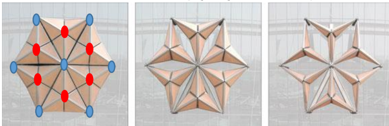
شکل ۶- ج) سازه اوریکامی که از راست به چپ به صورت باز، نیمه باز و بسته می باشد. همچنین نقاط آبی به عنوان تکیه گاه و نقاط قرمز به عنوان مرکز دوران صفحات می باشد. {origami-architecture}
