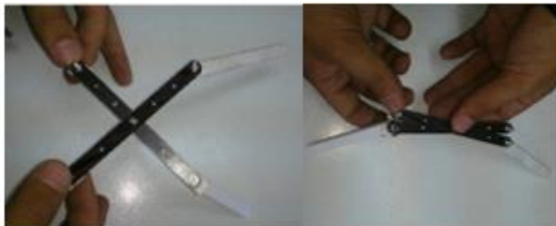
شکل ۱۰- آزمون اول، عملکرد تاشدگی در جهت محور افقی
