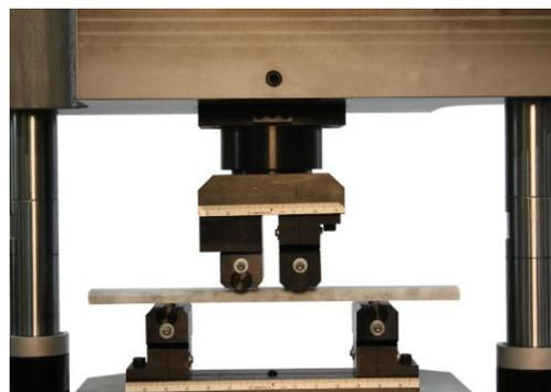
شکل ۳- دستگاه آزمایش استاندارد ASTM-C78
