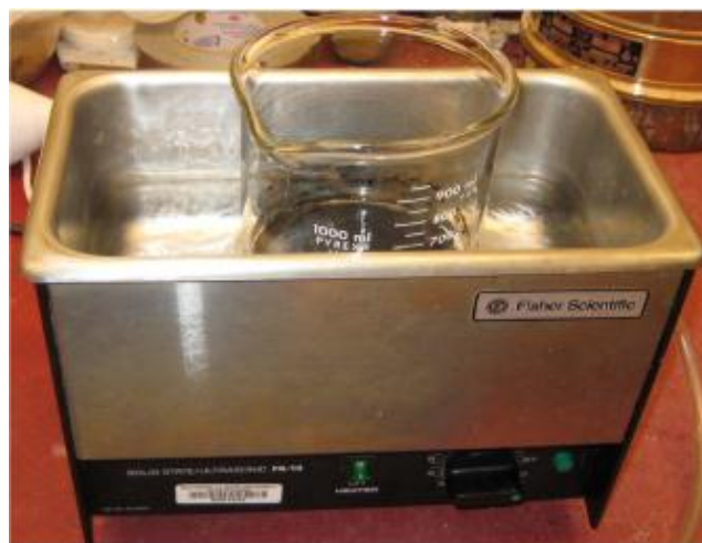
شکل ۵- حمام التراسونیک جهت دیسپرس کردن نانو لوله ها در آب
