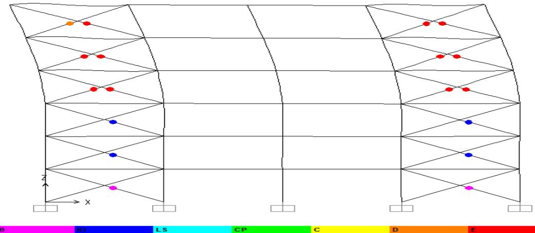
شکل ۳- روند تشکیل مفصل قاب دارای مهاربند ضربدری در راستای بار انفجار
