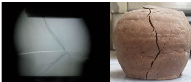
شکل ۱۰- نمونه مسلح شده با یک لایه ژئوکامپوزیت
