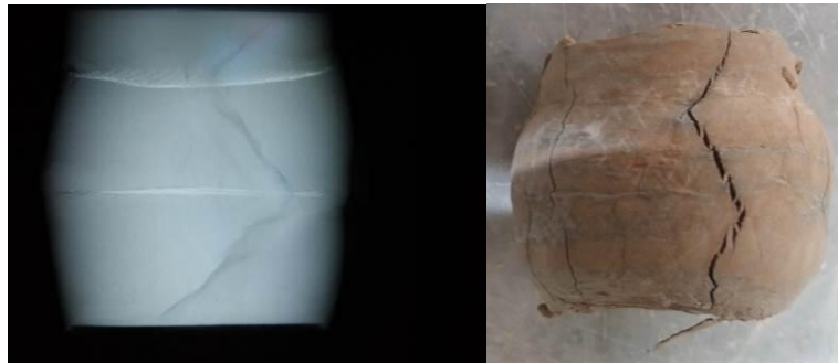
شکل ۱۱- نمونه مسلح شده با دو لایه ژئوکامپوزیت
