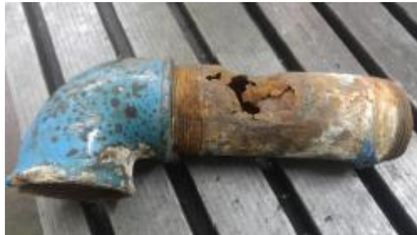
شکل ۱- قطعه تخریب شده و محل خوردگی
