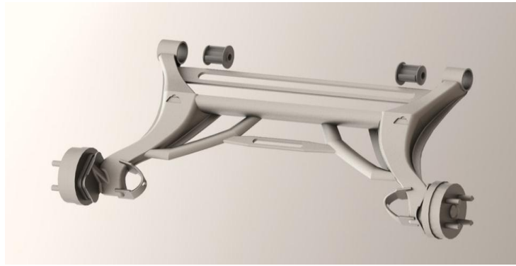
شکل ۱۹- نمای انفجاری بدنه اکسل عقب تقویت شده خودروی تیا با بوش پلاستیکی
