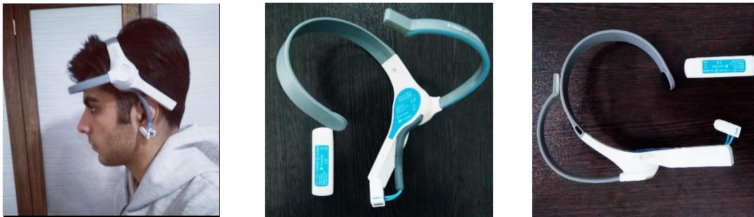
شکل ۱- هدست سه کاناله و طریقه ی قرار گیری آن بر روی سر برای دریافت سیگنال های مغزی
