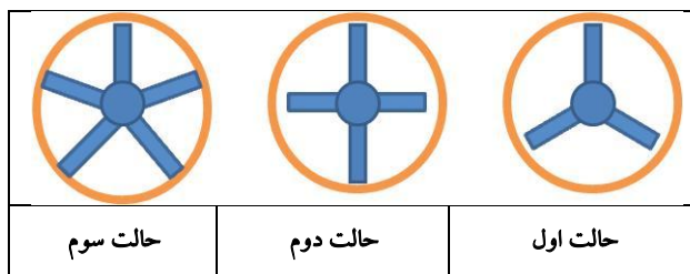
شکل ۲- سه نوع آشفته ساز مورد بررسی در مطالعه حاضر
