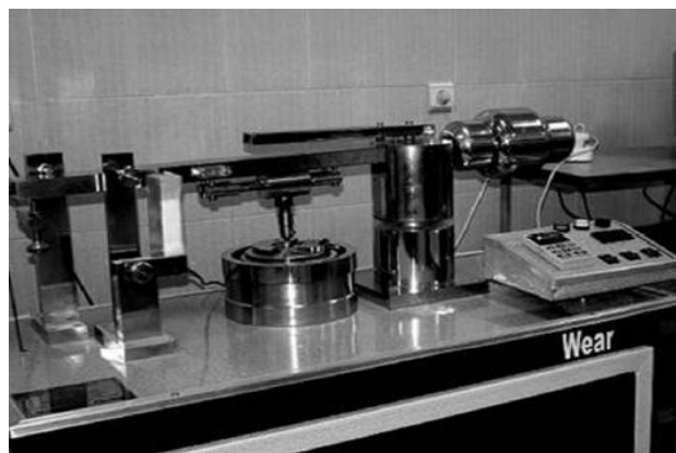
شکل ۵- دستگاه آزمایش پین بر دیسک استفاده شده در پروژه
